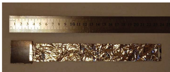
Рис. 5. Массо-габаритный макет фемтоспутника с двигателем «Импульс-С» на ленточной подвеске для лётного эксперимента «Импульс-0» (рабочее положение)
