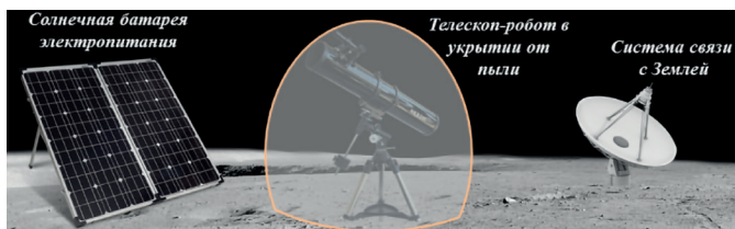
Рис. 3. Стационарный оптический телескоп-робот на поверхности Луны
