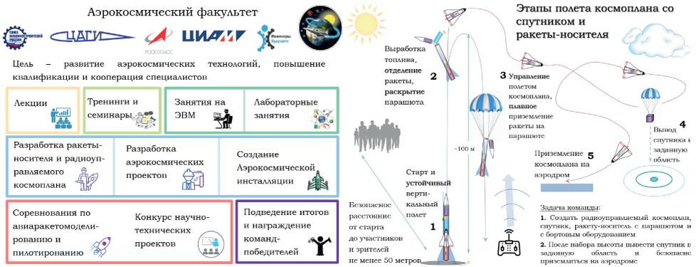
**Рис. 1.** Схема структуры образовательной программы и схема запуска модели многоразовой аэрокосмической системы — ракеты с закреплённой на ней космоланом (размер ракеты 2,2 м, космолана 0,7 м, масса около 2,5 кг). Вывод макета спутника в рамках практикума 2024 года не осуществлялся
