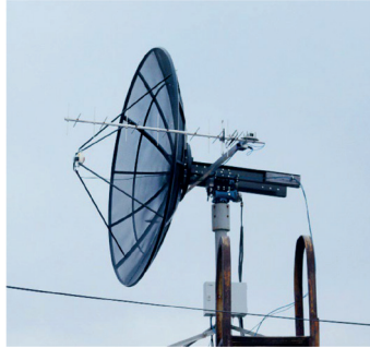
Рис. 3. Наземная станция управления
